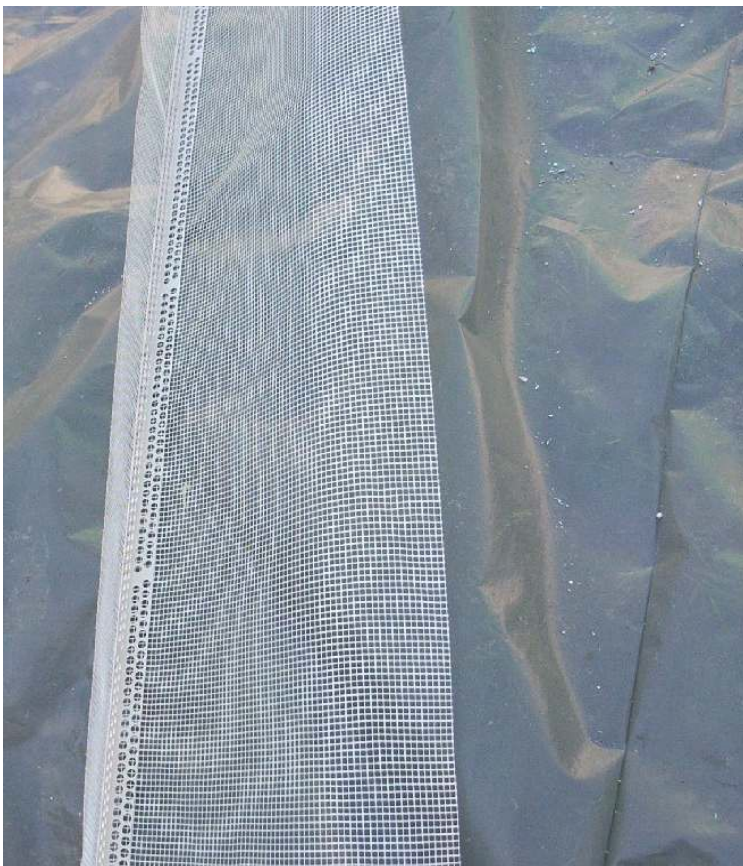
Abbildung 5-11: Kantenschutzprofil mit Gewebearmierung
