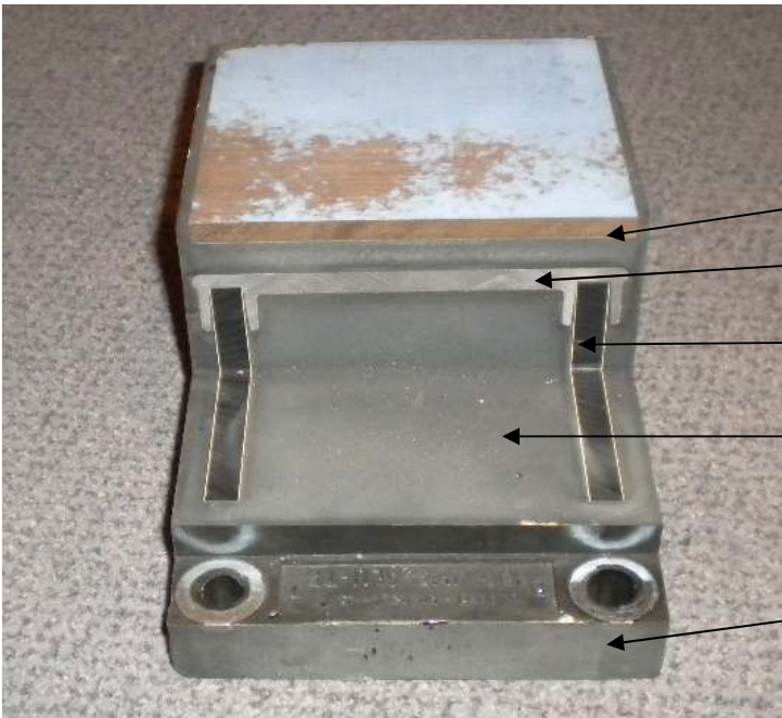
Abbildung 4-52: Schwerlastelement mit aufgeschnittener Montageplatte
