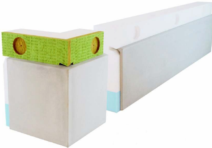
Abbildung 3-7: Vorfabrizierte und vor-konfektionierbare Sockelelemente aus Polystyrol mit Glasfaserbeton (GFB) Abdeckung
